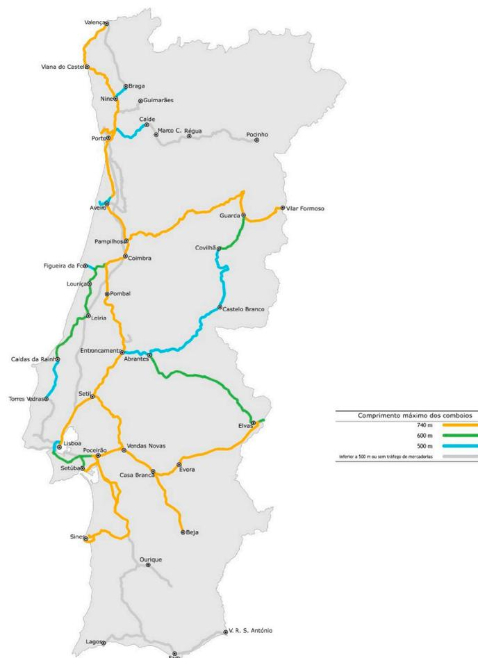
Figura 3. Comprimento máximo dos comboios de mercadorias na rede ferroviária após os investimentos previstos no PNI 2030.
