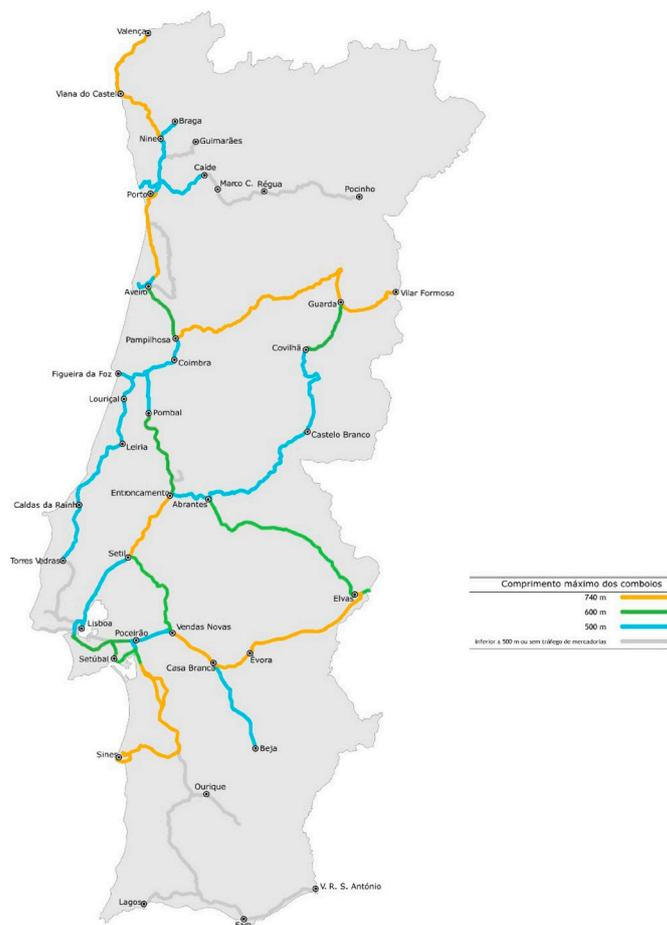
Figura 2. Comprimento máximo dos comboios de mercadorias (3) na rede ferroviária após a conclusão do programa de investimentos Ferrovias 2020.
